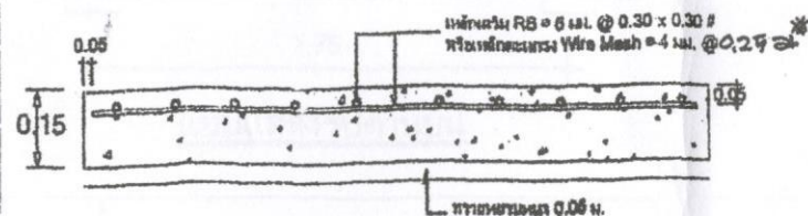
แบบขยายรูปตัดแสดงการเสริมเหล็ก
